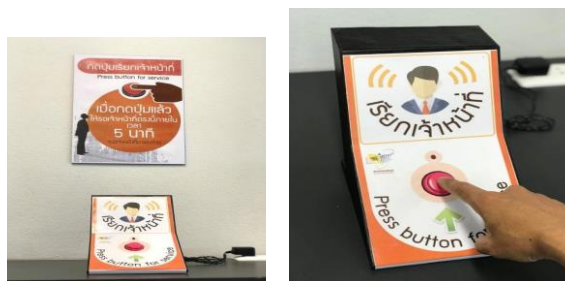
ภาพที่ 3 ต้นแบบเครื่องกดปุ่มเพื่อเรียกหาเจ้าหน้าที่ผ่านไลน์
