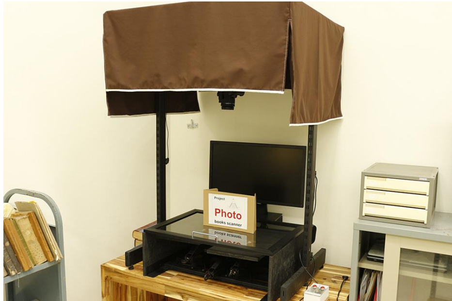
ภาพแสดงเครื่องทำสำเนาหนังสือโบราณเป็นหนังสืออิเล็กทรอนิกส์ : Book Scanner
