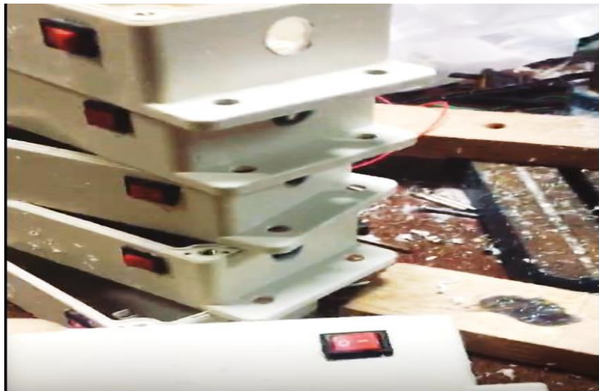
ภาพที่ 11 นำกล่องไปเจาะรู และติดสวิตช์และที่เสียบ Adapter
