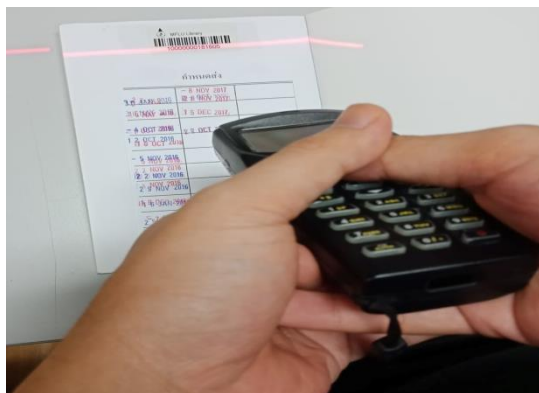
ภาพที่ 2 ใช้งานของเครื่องอ่านบาร์โค้ดแบบพกพาในการอ่านและบันทึกรหัสบาร์โค้ดของทรัพยากรสารสนเทศ
