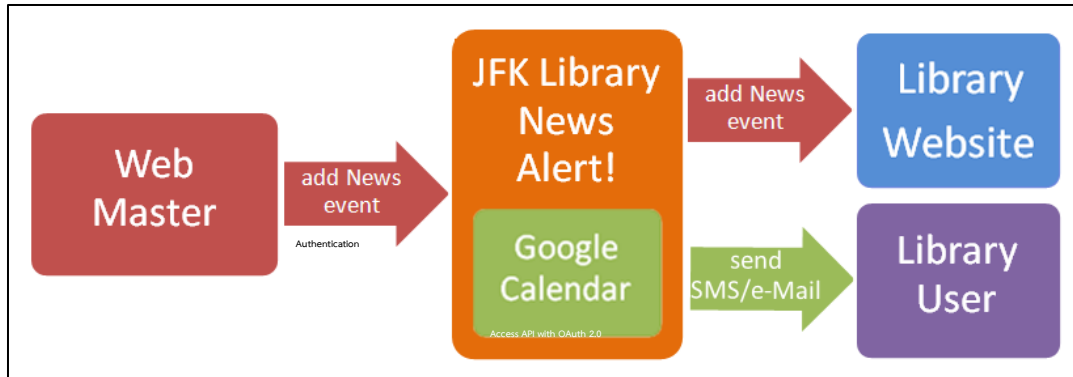
รูปที่ 5 ผังการทำงานของระบบ JFK Library News Alert! ที่ทำหน้าที่เพิ่มข่าวประชาสัมพันธ์ขึ้นสู่เว็บไซต์ห้องสมุด และส่ง SMS หัวข้อข่าวถึงผู้ใช้ที่รับบริการนี้
