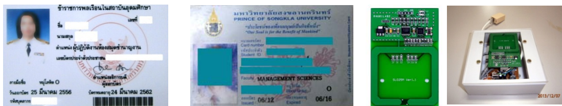
ภาพตัวอย่างบัตรข้าราชการพลเรือนและบัตรนักศึกษามหาวิทยาลัยสงขลานครินทร์ชนิด RFID และหัวอ่าน RFID
