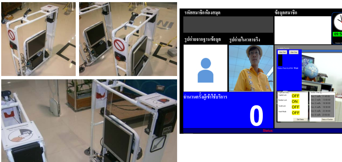
ภาพแสดงประตูทางเข้าอัตโนมัติ Smart Gate และหน้าจอโปรแกรมควบคุมประตูทางเข้าอัตโนมัติ Smart Gate ในการพัฒนาประตูทางเข้าอัตโนมัติ Smart Gate (version 3) จะแบ่งเป็นภาคส่วนต่างๆ ดังนี้
